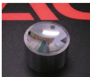
図7 周速一定・クロス研削加工
