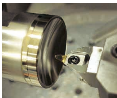
図9 回折形状金型加工
