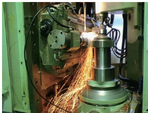
図7 cBNホブによる仕上げ切削の様子 平歯車:モジュール6, 歯数31,歯幅50mm ホブ:外径150mm, 1条, 18溝 切削速度900m/min
