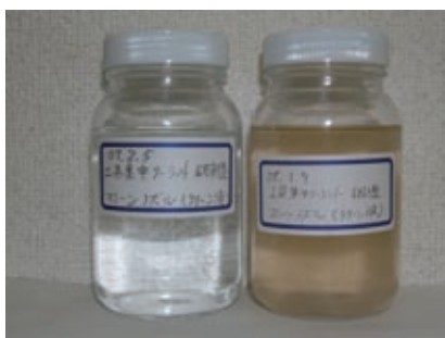
図11 装置導入直後(左)→導入後8ヶ月経過加工液比較
