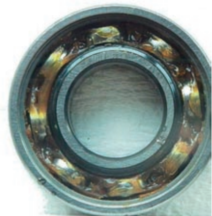
(b) 接触シールド軸受に非エステル系の合成油基油グリースを封入したもの
