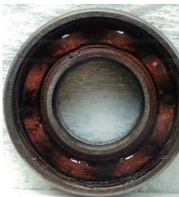
(a) シールド軸受にエステル系基油グリースを封入したもの
