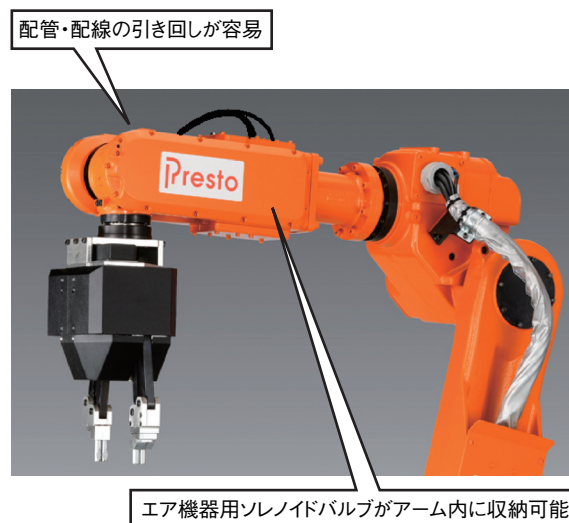
図6 手首側アプリケーション配線・配管
