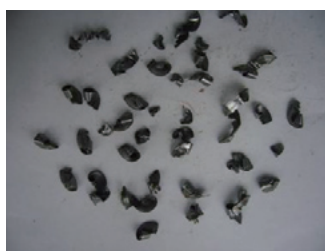
アクアドリルNWDX型の切りくず形状
