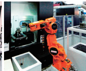
図4 MR20による、5軸マシニングセンターへの鋳物ローディング
