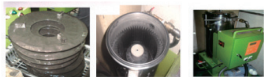
油性加工液用電界プレートろ過装置とその効果
