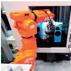
図3 MR20による、5軸マシニングセンターへの素材ローディング
