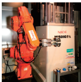
図1 ハイブリッドブローチ盤 (Mi5010PA) へのローディング
