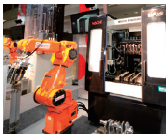
図2 フレキシブルマイクロフィニッシュ (MF.xx) へのクランクシャフトローディング
