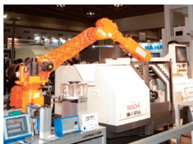
図5 内面研削盤 (IG-06SA) へのギヤローディング
