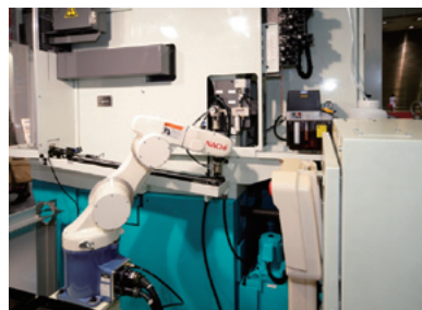
図6 VS05Eによる、高速ギヤ加工ラインでのギヤアンローディング
