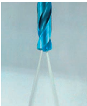
図2 アクアドリルEXオイルホールの内部給油状態
