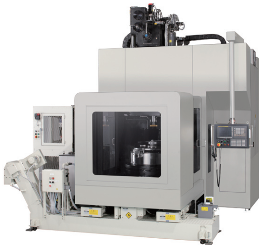
図2 工程集約型歯車加工機 「ギヤシェープセンタ GM7134」
