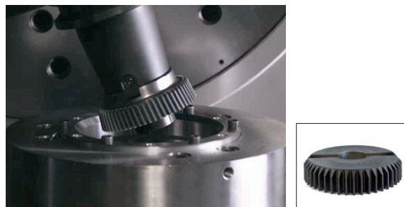
[スカイピング加工] 少量多種生産に適する
