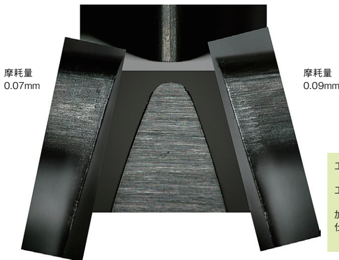
図10 超硬スカイピングカッタの摩耗写真
