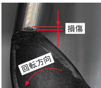
図7 スカイビングカッタの損傷形態
