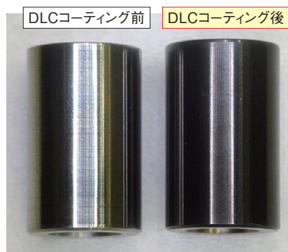
図7 プランジャ DLCコーティング
