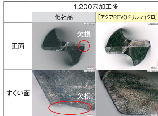
図12 SUS304 1,200穴加工後の摩耗状態
