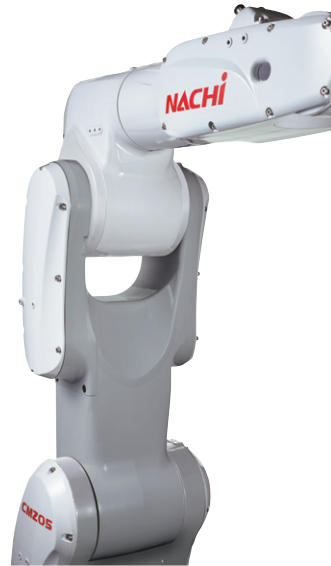
図5 J3軸挟み込まれ防止構造(すきまを確保)
