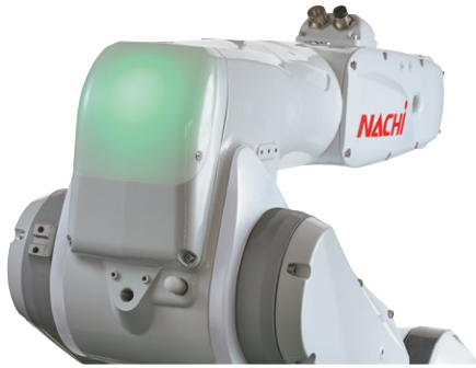
図2 背面ランプ点灯(衝突検知機能ON)
