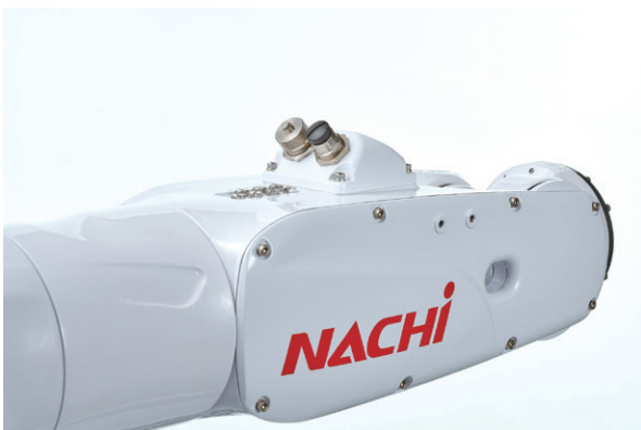
図4 アーム上コネクタ傾斜設置(丸みを帯びた形状)
