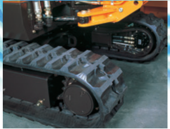
ミニバックホーに装備された小形走行モータ
