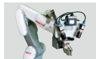
中空手首構造を活かした配線の引き回し例
